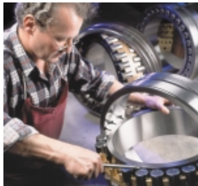
Desmontaje de un rodamiento oscilante de rodillos
