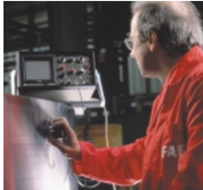
Revisión del camino de rodadura de un aro interior
